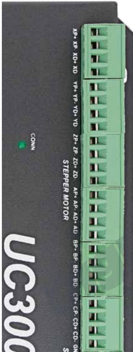
如左图中的端子可以提供6轴步进/伺服控制输出接口。每个轴的接线定义为方向信号+/方向信号-，脉冲信号+/脉冲信号-。输出信号电压为5V。
